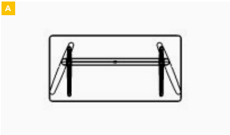
Colocación de los pies a 22° grados
